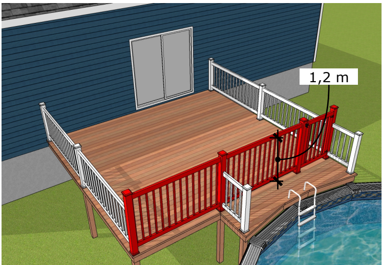
GALERIE À LA MÊME HAUTEUR QUE L'ENCEINTE
