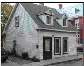
« **mur pignon** » : mur d'extrémité d'un bâtiment surmonté d'un toit à deux versants se terminant en pignon.
