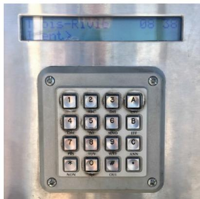
Photo 2 : Clavier numérique sur le terminal du système de contrôle d'accès
